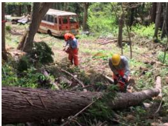
樹齢七五歳の杉を2.4mに玉切り 製材してテラスの材料にします
